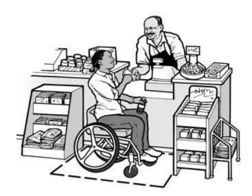
Reducir la altura de un mostrador y proveer un espacio despejado en el piso son componentes críticos de un mostrador accesible de servicio.
